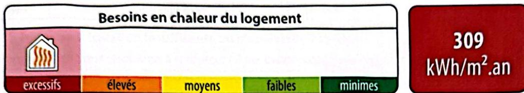
Ces besoins sont les apports de chaleur à fournir par le chauffage pour maintenir constante la température intérieure du logement. Ils dépendent des pertes par les parois selon leur niveau d'isolation thermique, des pertes par manque d'étanchéité à l'air, des pertes par la ventilation mais aussi des apports solaires et des apports internes.
